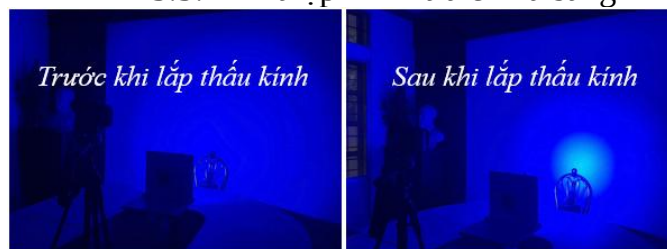
Hình 5.6: Chất lượng chiếu sáng thấu kính được đúc từ máy thiết kế - chế tạo sáng gấp hơn 5 lần
